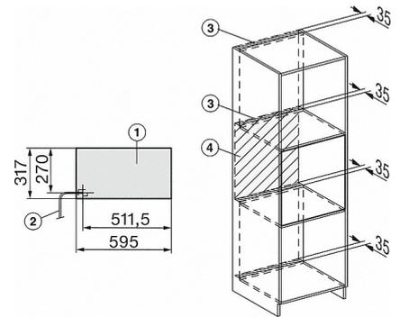
3) Lüftungsausschnitt min. 180 cm<sup>2</sup>
