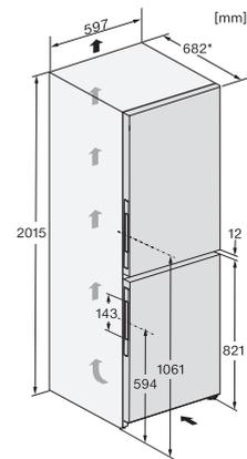
KFN4898CD brws, KFN4795DD bb, KFN4395CD bb, Aufstellskizze (\*Fußnote) (Skizze)
